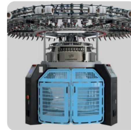
Construcción de máquinas de tejido circular de gran diámetro de una y doble fontura, con accionamiento mecánico y jacquard electrónico.
